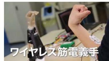
筋肉が動く際に発生する微弱な筋電信号を読み取ることで、
