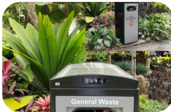
【写真3】AIが搭載されたごみ箱。ごみの回収作業を減らすために、ごみの量をセンターで確認できるシステムを内蔵。現場の人員を減らすことに成功している。
